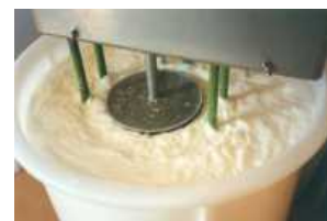
El pasteurizador tiene incorporado un batidor sumergible
