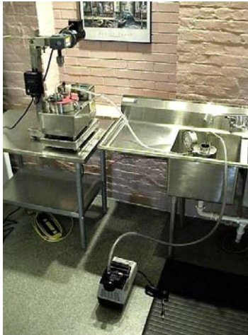
CA350 - Sistema de Desarrollo de cocción con agitación a escala. Se muestra con accesorios opcionales de vacío, bomba y recolección de condensados.
