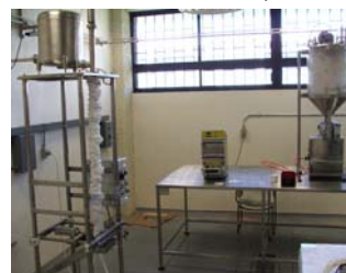
Sistema de dosificado para la planta con conexiones en acero inoxidable.
