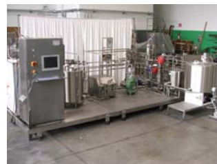
Planta polivalente de productos lácteos serie DP con 100 Lt/h de capacidad.
