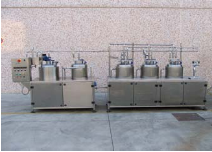
CV753 - Fabrica de cerveza Integrada como paquete con todas sus tuberías de interconexión
