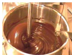
CHOCOLATE Prueba de temperado. También se dispone de un mezclador tipo bola para la reducción de partícula
